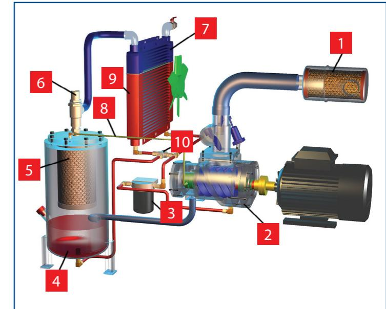
10°C выше температуры среды. Масло, которое осталось в маслоделителе, подается по патрубку **8** к винтовому механизму. Протеканием масла через радиатор **9** управляет терmostat **10**.
